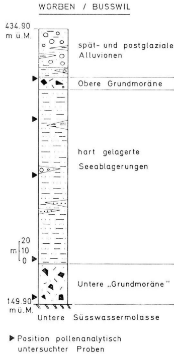
Abb. 2: Schematisches Lithologisches Profil der Bohrung Worben/Busswil nach KELLERHALS & TROEHLER (1976).
