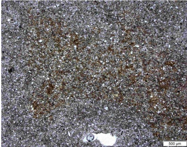
M: Eisenoxidimprägnierung der Matrix im unteren Schliffabschnitt
