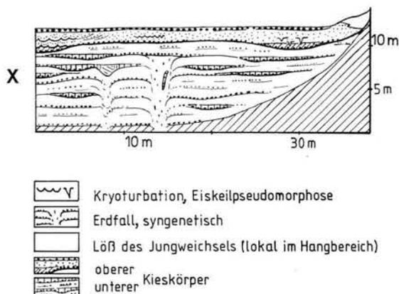
Abb. 5: Aufbau der Älteren Niederterrasse zwischen Herzberg und Hörden, schematisiert.
