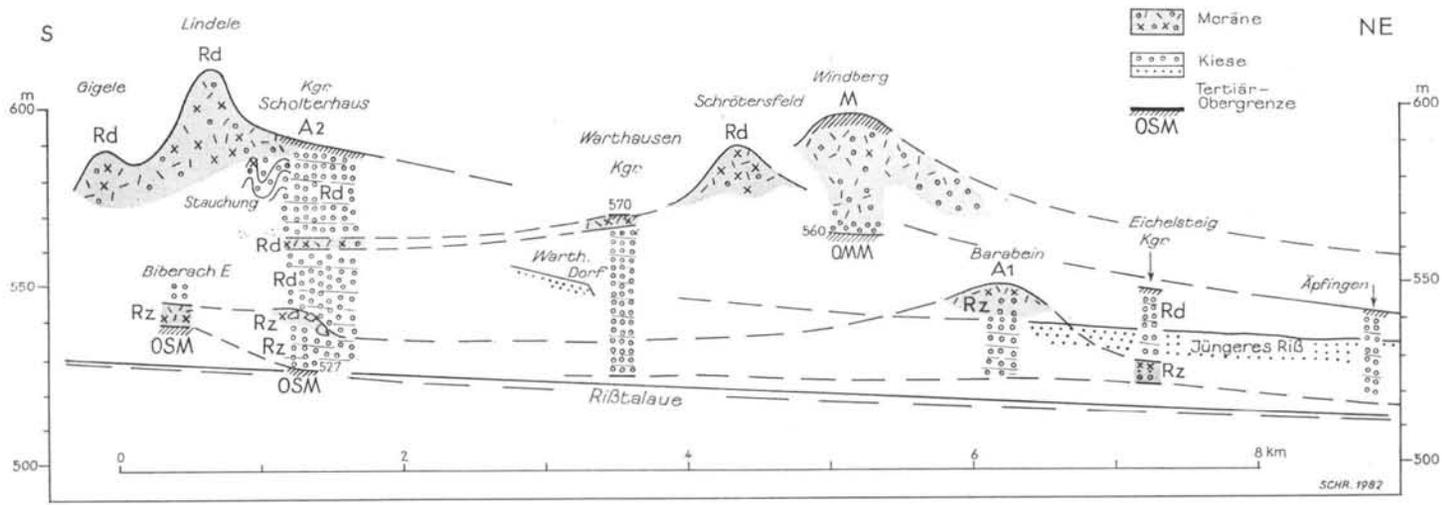
Abb. 7: Längsschnitt durch das Rißtal (vgl. Text S. 150)
