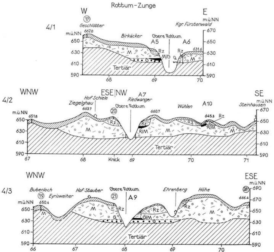
Abb. 4: Quartärgeologischer Querschnitt durch die Rottum-Zunge, 12,5 x überhöht.
