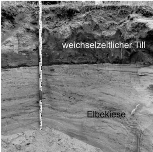
Abb. 5: Weichselzeitlicher Till im Hangenden der Wietstocker Kiese am Nordrand des Lindenberg (R <sup>45</sup>93745, H <sup>57</sup>5796593), Aufnahme 2003.
